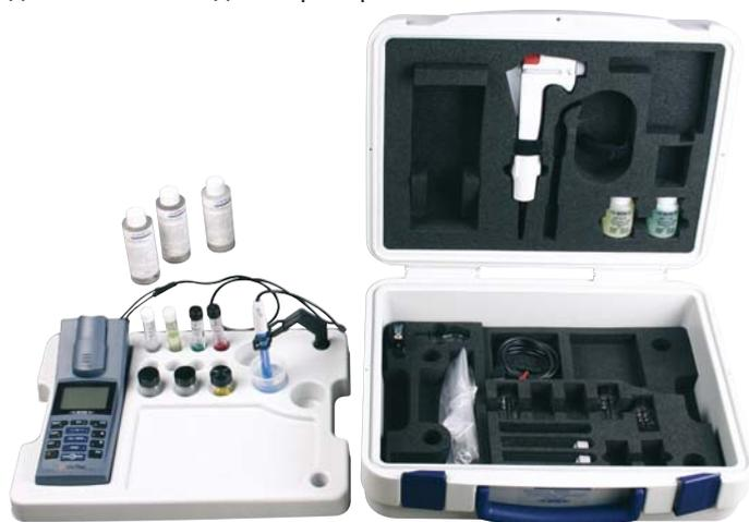
Прибор можно заказать в минимальной или расширенной комплектации. В этом случае поставляется готовая к работе мобильная лаборатория — в поставку входит рН-электрод и буферные растворы, стандарты мутности, программа для передачи данных на компьютер, мелкие принадлежности и прочный кейс со вставкой, которую можно использовать вместо небольшого лабораторного стола. Углубления помогут надежно разместить прибор, реагенты, кюветы и электрод.
